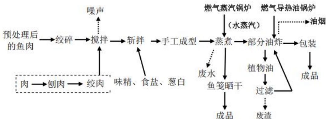
图 2-3 项目鱼糜制品生产工艺流程图
