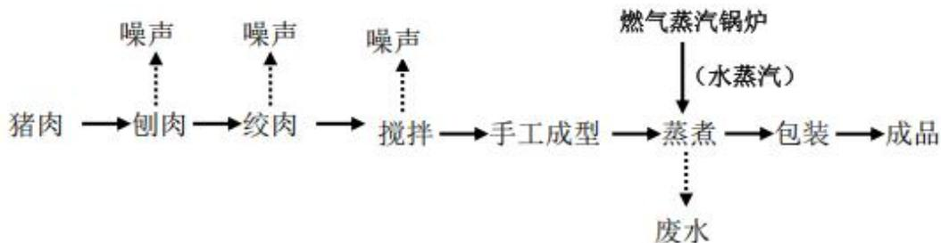
图 2-3 项目肉糜制品生产工艺流程图
